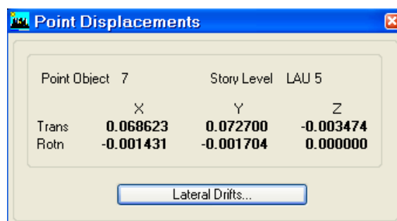
Hình 16: Chuyển vị đỉnh khi tính đến tải trọng động đất theo Phổ phản ứng đàn hồi.
